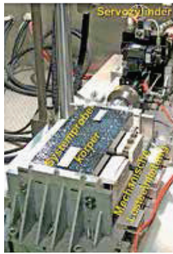
Abbildung 8a und 8b: Komplexer Versuchs- stand der BAM in der Versuchsausstattung zur Untersuchung von FÜ-AS
